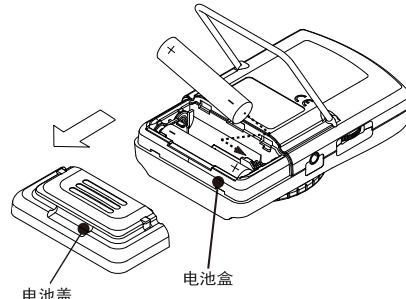
将电源开关切换至OFF。打开位于节拍器背面的支架，往左图的箭头方向滑动电池盖，将其卸下，取出电力耗尽的2节电池。按照与电池盒内极性显示相同的方向，从负极侧放入2节新电池，然后安装电池盖。安装完成后，接通电源，确认动作正常。
